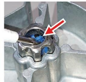
Das Maß, für den über den Mitnehmerrand hinausstehenden Teil der Torxwelle inklusive der Arretierzunge, ist gleich dem Maß der für die bis dato verwendete Mitnehmersicherung mit Schraube und Unterlegscheibe. Es beträgt in beiden Fällen 8 mm.
